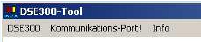
Über das Menü "Kommunikations-Port!" wird zunächst die serielle Schnittstelle angegeben über die der DSE300-4 mit dem PC verbunden ist.
