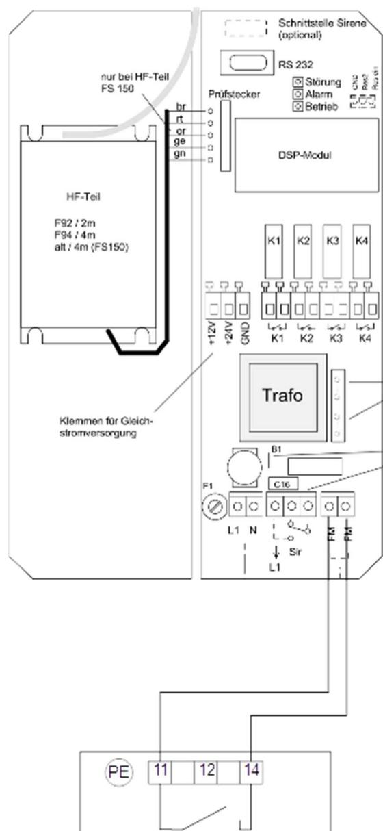
Ab einer Leitungslänge > 2m wird die spannungsgesteuerte Auslösung empfohlen. Es ist eine Auslösung mit 12V DC, 24V DC oder 230V AC möglich. Am FSE160 muss dann das passende RP2 – Modul gesteckt sein. Die zwei Steckbrücken werden gegen das RP2 – Modul getauscht.
