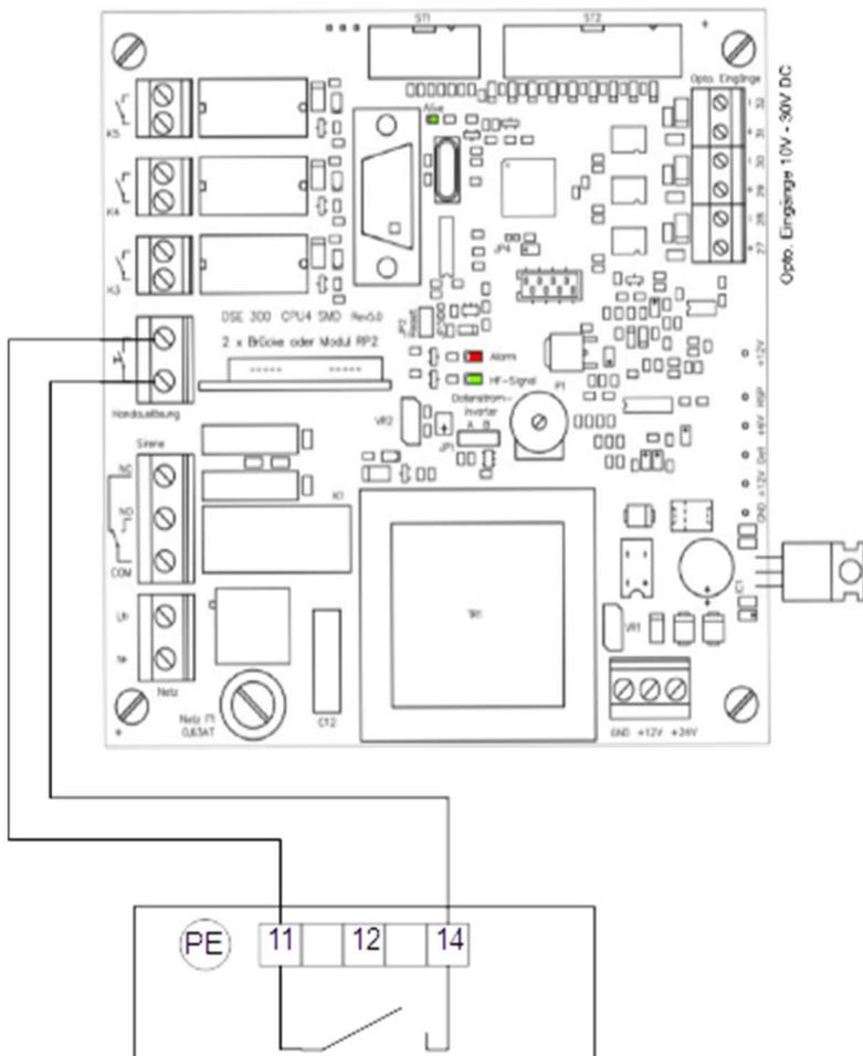
Ab einer Leitungslänge > 2m wird die spannungsgesteuerte Auslösung empfohlen. Es ist eine Auslösung mit 12V DC, 24V DC oder 230V AC möglich. Am DSE300 muss dann das passende RP2 – Modul gesteckt sein. Die zwei Steckbrücken werden gegen das RP2 – Modul getauscht.
