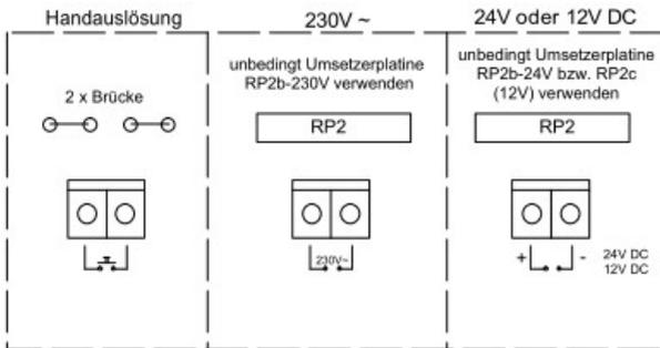
Bei unserem aktuellen DSE300 können Sie die 12V Versorgung direkt aus dem DSE300 beziehen (siehe Anschaltbeispiel unten). Bei älteren Varianten müsste hierfür die Diode D2 durch eine Sicherung mit 200mA ersetzt werden.
