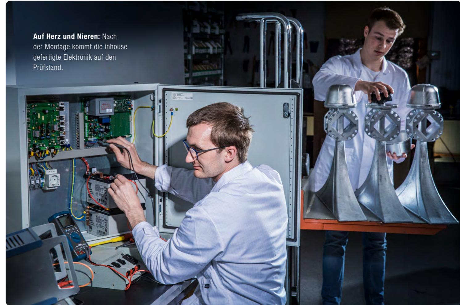
**Auf Herz und Nieren:** Nach der Montage kommt die inhouse gefertigte Elektronik auf den Prüfstand.
